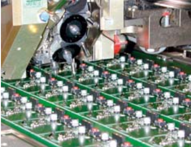
Hekatron stellt seine Heimrauchmelder in modernen Produktionsverfahren her. Anschließend werden die Melder in aufwändigen Testverfahren auf Qualität und Funktionstüchtigkeit geprüft.
